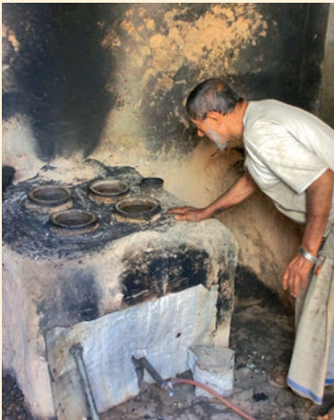
In diesen Öfen wird das Rosenwasser destilliert
