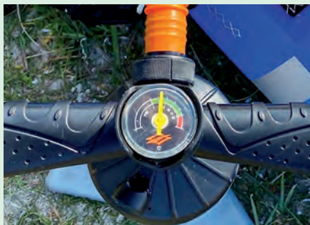
Manometer an der Pumpe hilft, den Wing mit dem richtigen Druck aufzupumpen.
