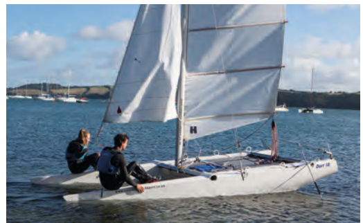
Weht der Wind vom Land aufs Wasser, ist es am sichersten, den Kat mit aufgeholtten Rudern und Schwertern rückwärts hinaustreiben zu lassen.
