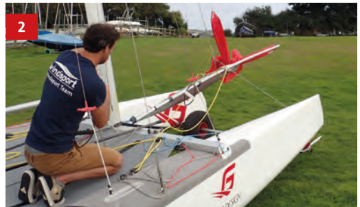
2 Erst wenn die Halsleine dichtgeholt ist, wird der Gennaker mit dem Fall nach oben gezogen. (Ein Einleinensystem holt Halsleine und Fall automatisch gleichzeitig dicht.)
