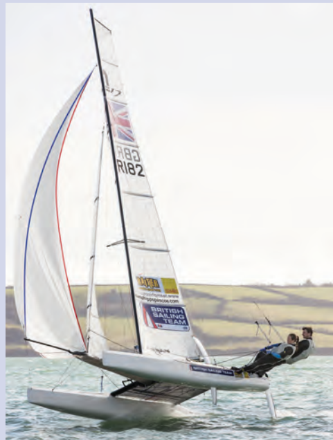
C-Foils liefern Auftrieb, heben das Boot aber nicht vollständig aus dem Wasser.
