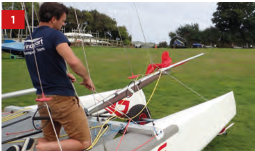
1 Bei einem Zweileinensystem wird zuerst der Hals des Gennakers mit der Halsleine an die Spitze des Gennakerbaumes geholt.
