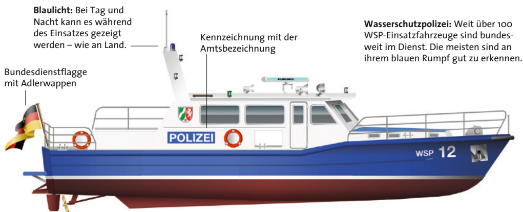
Rheinstreifenboot WSP 12: Zwölf Boote dieses Serien-Typs gehören zur WSP Nordrhein-Westfalen. Sie sind 17,75 m lang, der Rumpf ist aus Stahl.
