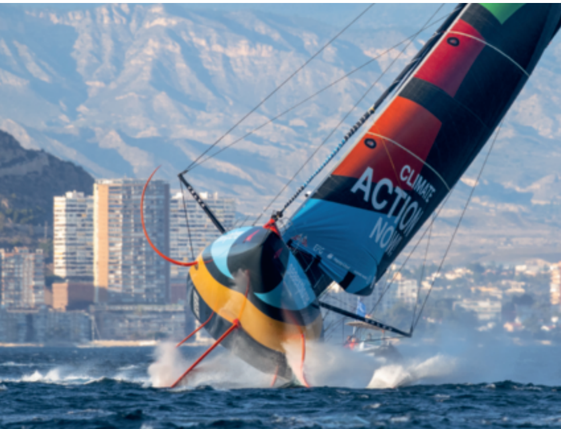
Abflug vor Alicante: Die gebogenen Foils heben die Malizia aus dem Wasser.
