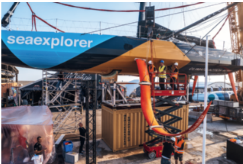
Passen sie? Die neuen Foils werden in den Rumpf geschoben.
